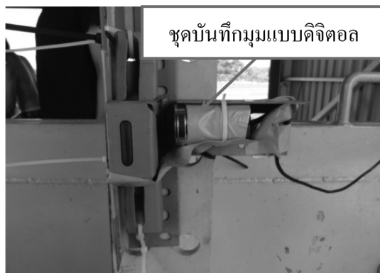
รูปที่ 6. การติดตั้งอุปกรณ์วัดมุมแบบดิจิตอลและบันทึกข้อมูล
