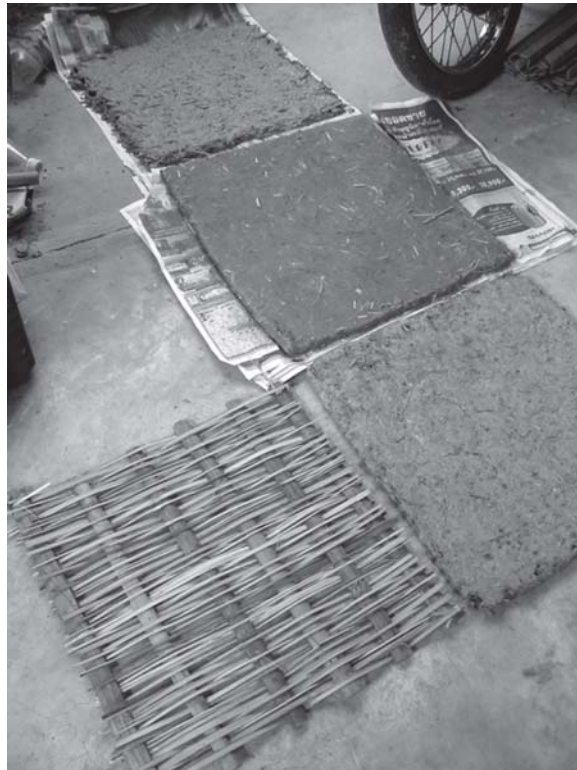
รูปที่ 7 แสดงตัวอย่างการสานตอกไม้ไผ่และแผ่นผนังทดลองที่ทำขึ้นเพื่อหาส่วนผสมดินที่เหมาะสมในการฉาบเนื้อไม้ไผ่
