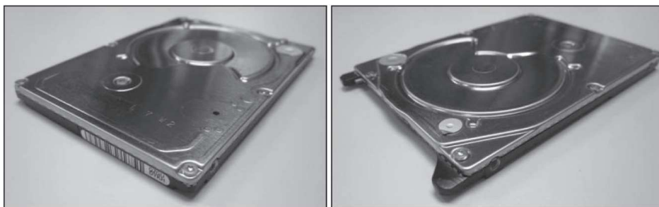
รูปที่ 3. ลักษณะรอยรั่วที่รอยต่อระหว่าง Top cover และ Base
