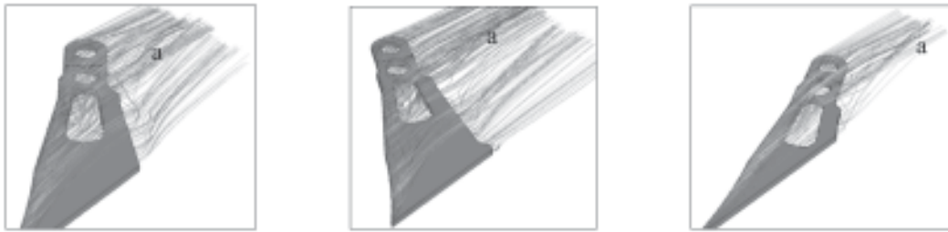
รูปที่ 4. แสดง Path line ของแขนหัวอ่าน/เขียนฮาร์ดดิสก์ที่ตำแหน่ง 30°, 45° และที่ 60° ตามลำดับ
