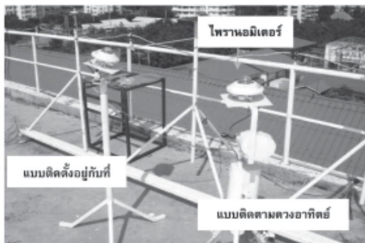
รูปที่ 6. การวัดค่ารังสีรวมอาทิตย์ โดยการติดตั้งไพรานอมิเตอร์ ด้วยอุปกรณ์ทั้งสองแบบ
