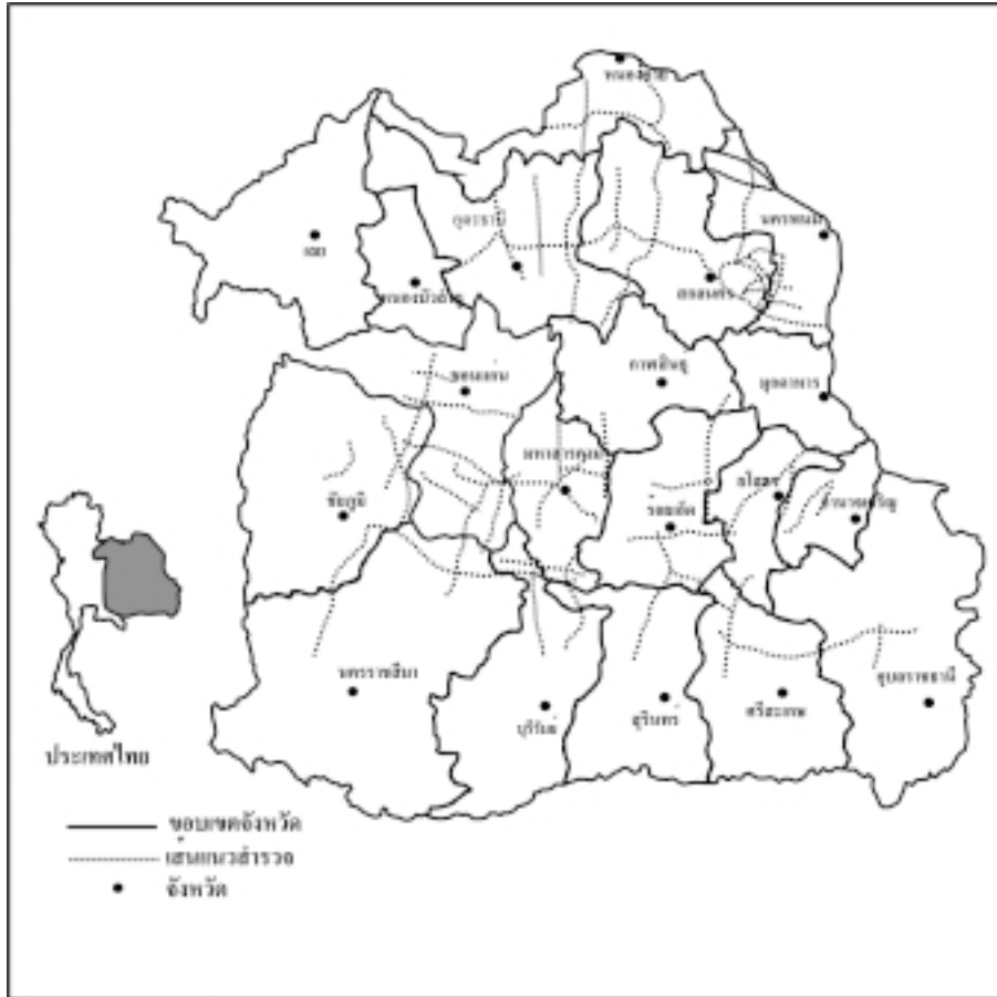
รูปที่ 1 แผนที่แสดงตำแหน่งของแนวสำรวจคลื่นสั้นสะท้อนที่ใช้ในการวิเคราะห์หากการวางตัวของเกลือหิน และขอบเขตของพื้นที่จังหวัดในภาคตะวันออกเฉียงเหนือ
