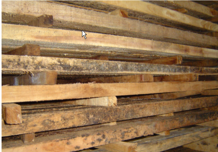
รูปที่ 4. ไม้ระแนงขนาดไม่เท่ากันและไม่เรียงเป็นแนวเดียวกัน
