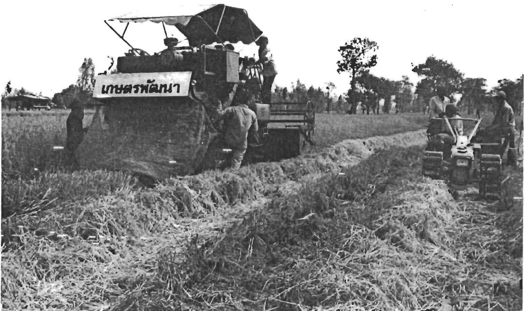
รูปที่ 3 การเก็บตัวอย่างจากช่องทางออกฟางและสิ่งเจือปน
