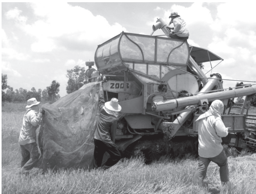
รูปที่ 2. การเก็บตัวอย่างความสูญเสียจากชุดนวด
