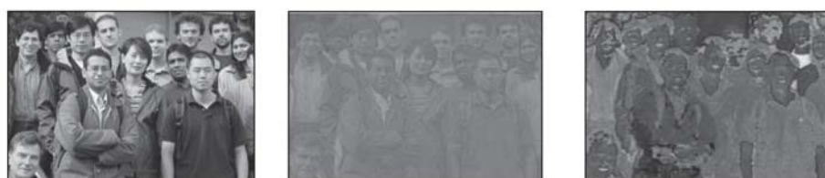
(ก) ภาพในโหมดสี RGB (ข) ภาพในโหมดสี YCbCr (ค) ภาพในโหมดสี HSV
